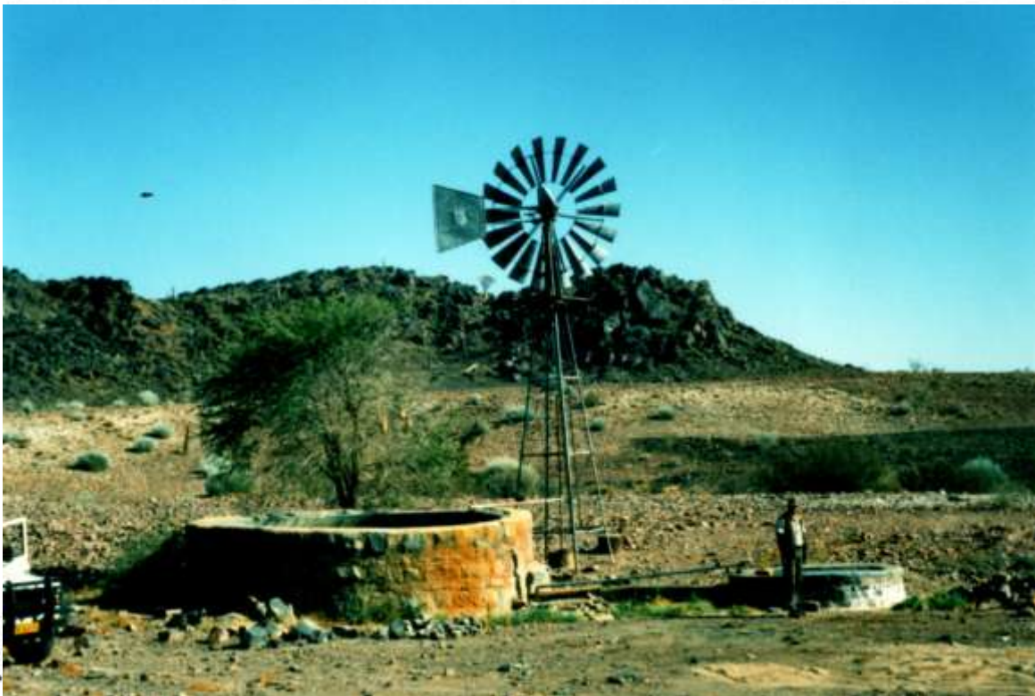
Windmotorpumpe an einer Wildtränke zur Steuerung der Großwildmigration in der Trockenlandschaft am Großen Fischflußcanyon. - Windkraft zur Abdeckung technischer Energienischen. (Windpumpe S2 "Mangaanpomp", Soutkuil im CNP, 1997)
