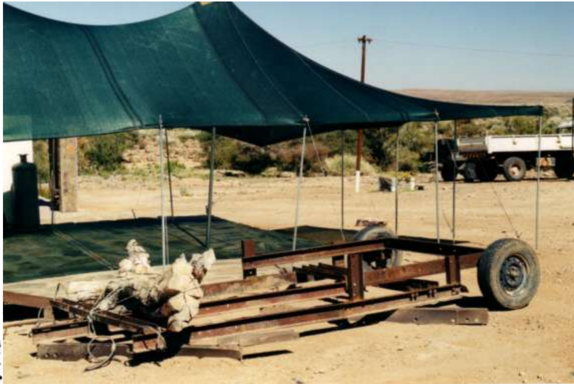
Selbstgebaute, höhenverstellbare "Padskrape" (Straßenhobel). - CNP-Patentmarke "Hamer, Draadtang en Bloudraad" für die speziellen Geländebedingungen am Großen Canyon. (CNP-Hauptbetriebshof, Anwesen Soutkuil, 1998)
